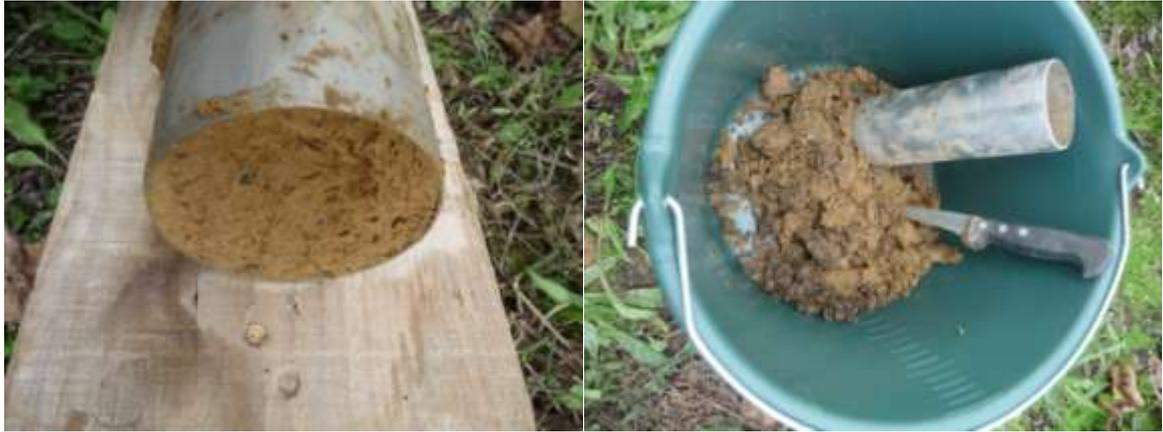
Figure 17 : Méthode utilisée pour les prélèvements au cylindre.
