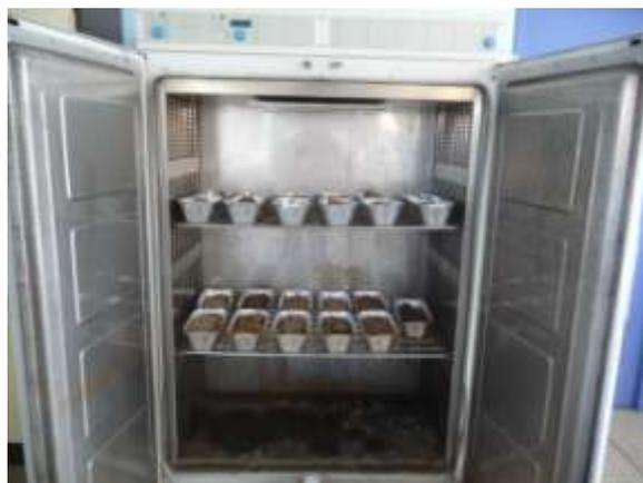
Figure 18 : Séchage des échantillons
